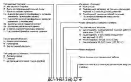
Рис. 2. Расшифровка маркировки оптического кабеля
