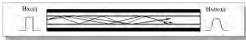
Рис. 17. Распространение света в многомодовом кабеле
